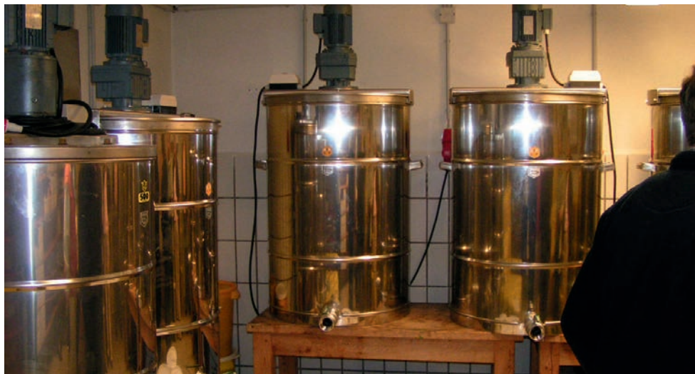
Rührfässer mit einem Fassungsvermögen von jeweils 600 kg
